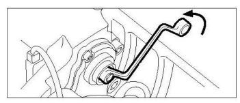
FIGURE 20 - BACKING-OFF (INCREASING) THE RUNNING CLEARANCE
